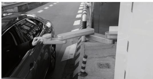
图 4 机械臂式自动发卡机器人发卡场景
