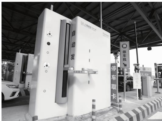
图 2 机械臂式自动发卡机器人
