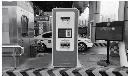
图1 固定双工位自动发卡机器人<sup>[9]</sup>
