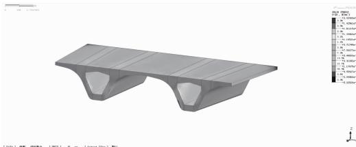
图 20 恒载作用下双箱腹板剪应力 S-ZX(单位:MPa)
