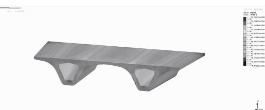
图 18 恒载作用下双箱侧腹板剪应力 S-ZX(单位:MPa)
