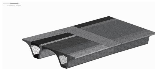
图 16 实体有限元分析模型
