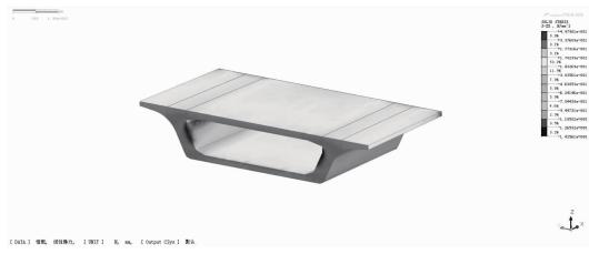
图 19 恒载作用下单箱腹板剪应力 S-ZX(单位:MPa)
