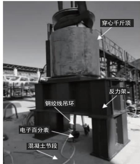
图3 拉拔试验装置
