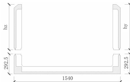
图 13 敞开段结构分块示意图(单位:cm)
