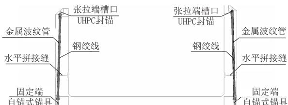
图8 敞开段(肋高 1.1 m)预应力钢束断面图(单位:cm)
