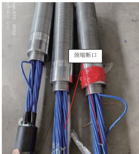
图5 GJ15-4拉索钢丝断口
