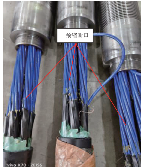
图6 GJ15-7 拉索钢丝断口
