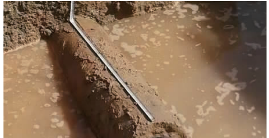
图9 管桩断桩长度测量图
